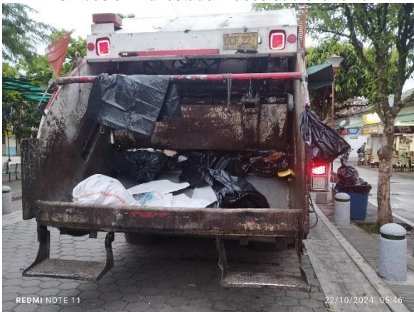
Foto 43. Vehículo con Placas OCF227- Vista trasera Estribos en mal estado- Luces sobre la tolva
