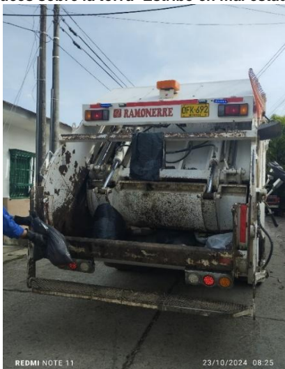
Foto 51. Vehículo con Placas OFK692 Tubo de escape por encima de la altura máxima
