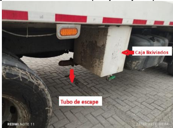
Foto 45. Vehículo con Placas OCF227 Caja de lixiviados- tubo de escape bajo la caja compactadora
