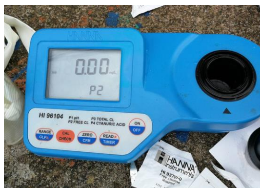
Figura 14. Equipo de medición parámetro de Cloro residual y pH
