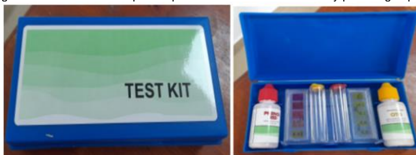
Imagen 36. Kit colorimétrico portátil para análisis de cloro residual y pH en agua potable
