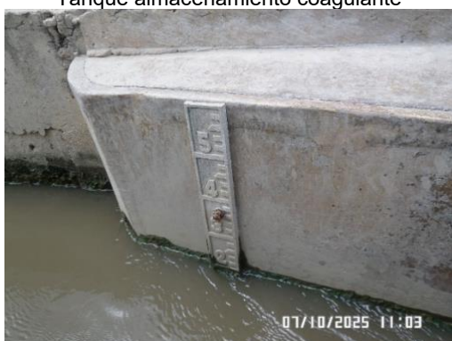
Regleta para medición de caudal al ingreso de la PTAP
