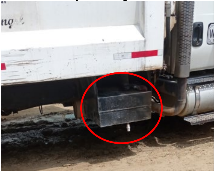
Foto 10. Caja de descarga de lixiviados
