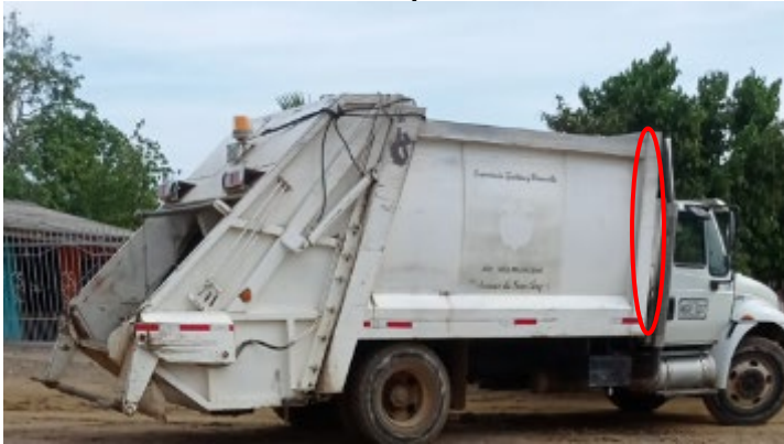
Foto 8. Costado lateral del compactador, tubo de escape
