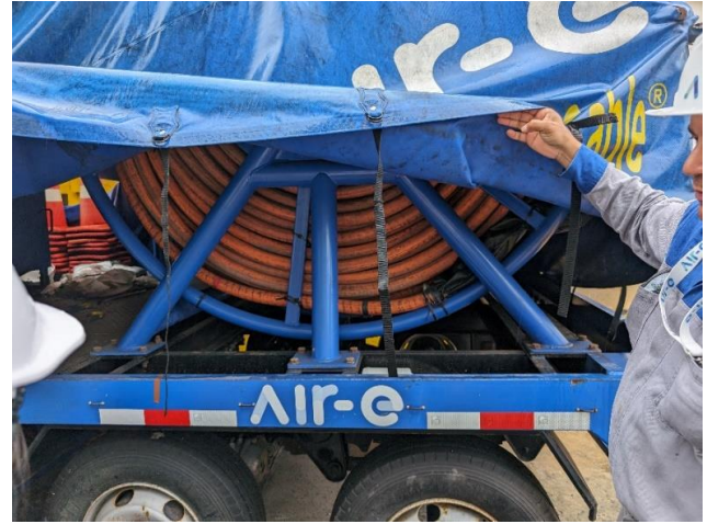
Cable tipo Jumper adquirido a través del plan de inversiones y que apoya actividades de mantenimiento y ejecución de inversiones.
