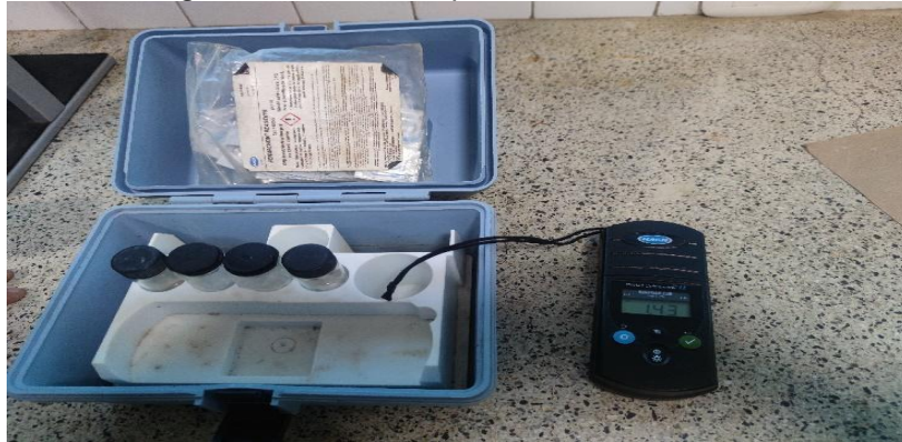
Imagen 28. Colorímetro para cloro residual HACH
