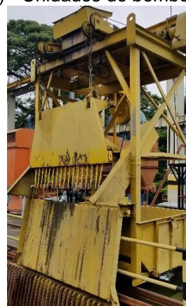
d) Estructura de limpieza.
